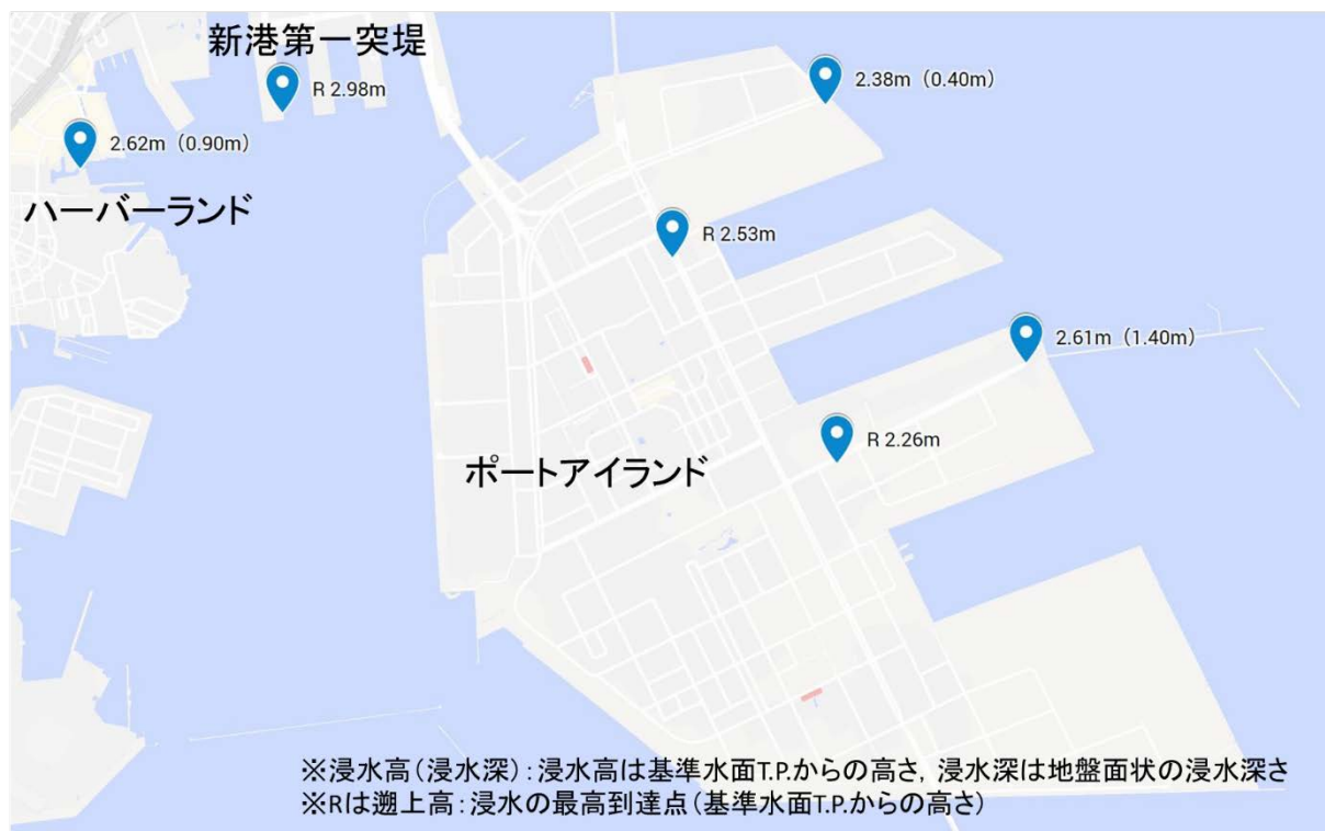
図3 ポートアイランドの浸水高(浸水深)
