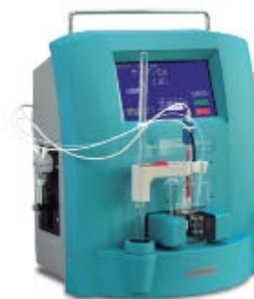
写真-2.3 TA・DIC 分析装置 (ATT-05, 紀本電子社製)
