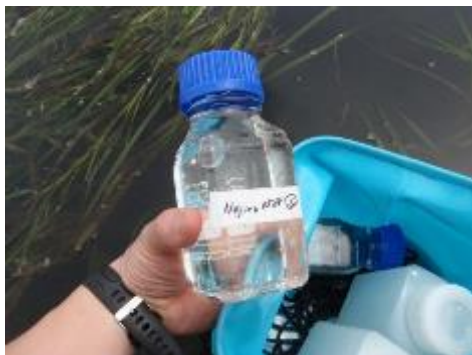
写真-2.2 TA・DIC 測定用サンプルの採取の様子
