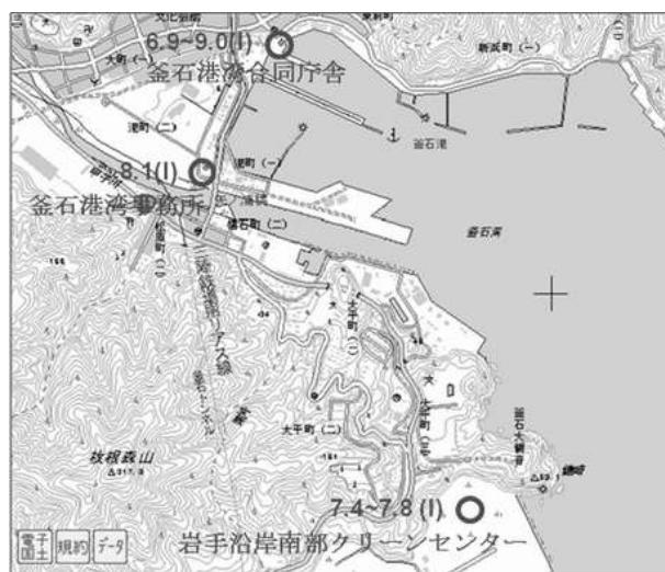
図-5.2.3.2 釜石港とその周辺の地図と津波痕跡高
