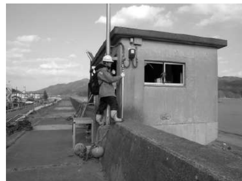
図-5.2.2.4 高浜地区の津波痕跡 (写真上：痕跡，写真下：前面の海岸線)
