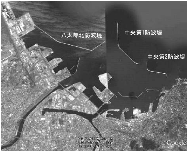
図-5.1.1.13 八戸港の防波堤配置
