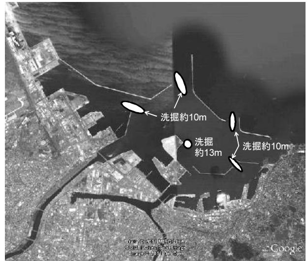
図-5.1.1.18 八戸港における洗掘
