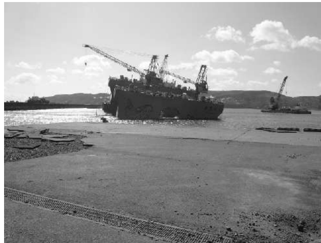
写真-6.2.1.6 諏訪下地区岸壁 (-10m) —流出したフローティングドック— (平成23年3月18日撮影)
