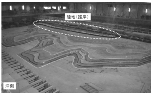
(a) 海底地形 (左手前：沖側，中央：護岸側)
