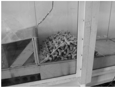
(b) 透過離岸堤を有する直立護岸
