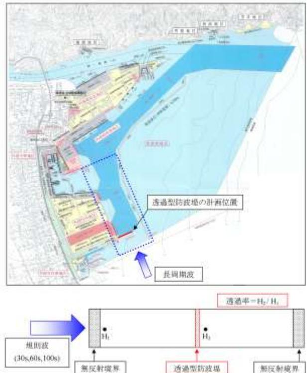
図-3 断面水路による長周期波計算のイメージ図
