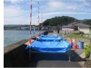
図-7 越波採取器の設置状況
