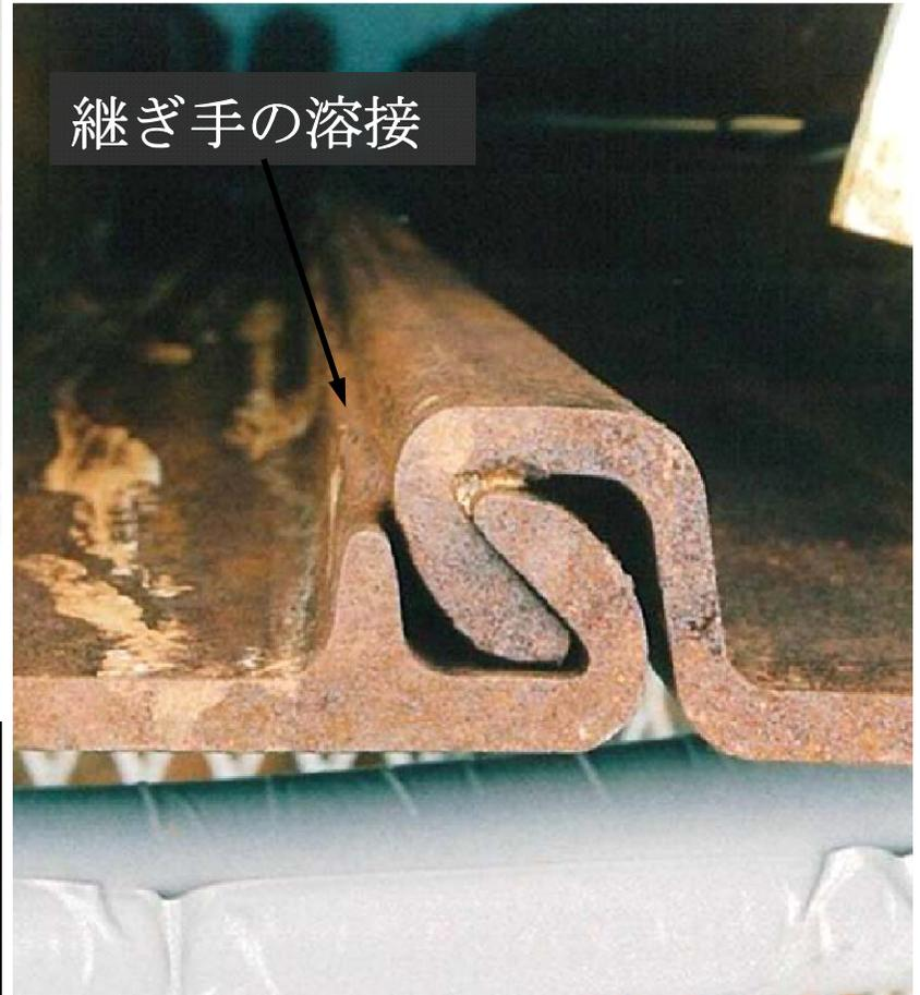
矢板のツメに設けられた溝に膨潤性ゴムを充填
