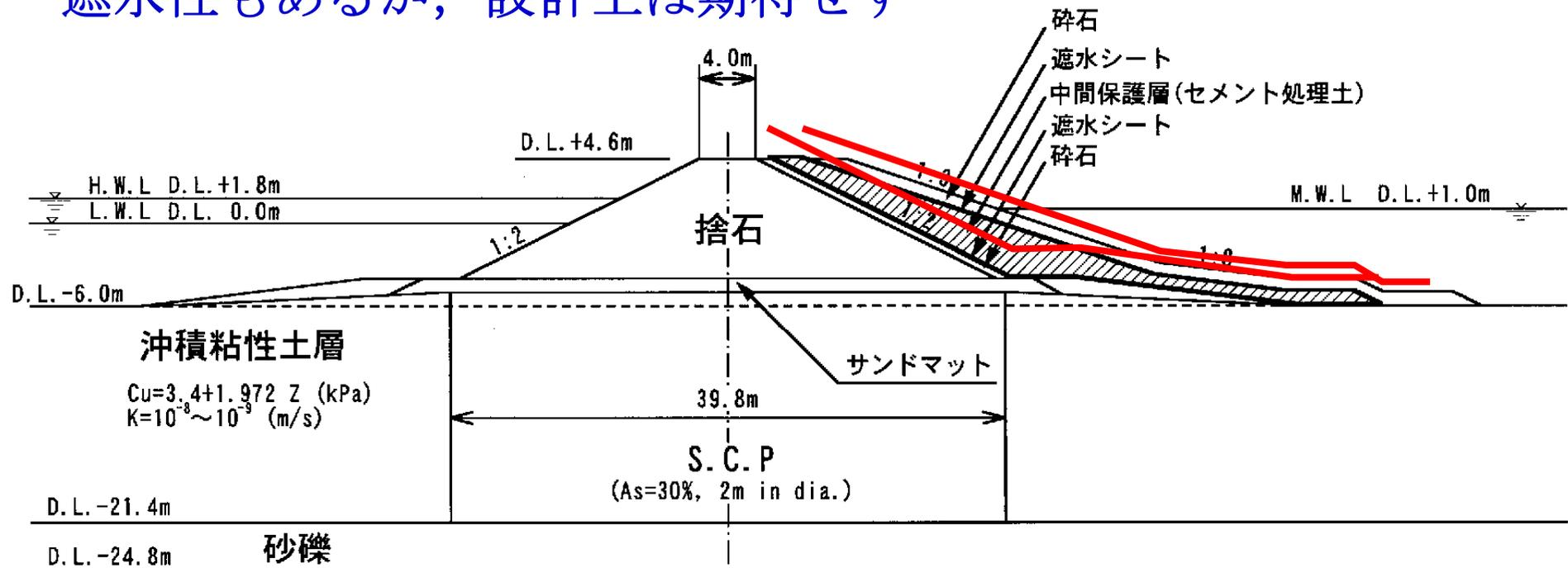
捨石式傾斜護岸による廃棄物埋立護岸の例
