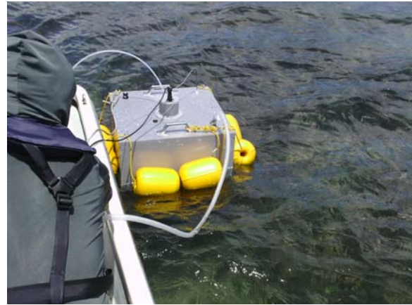
大気と海水の間での CO 2 の出入りを 観測する装置（チャンバーシステム）
