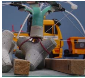
写真-1 凹部にブロック着地
