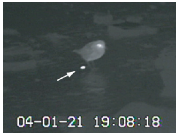
図3-7 排泄直後のシロチドリの熱赤外線ビデオ映像。背景 (現場温度) と比較し糞 (矢印) の温度が高いため、鮮明なコントラストが得られ、排泄速度の測定が可能となる (千葉県木更津市地先盤洲)。
