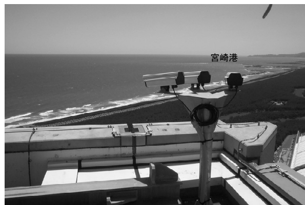
図-10 カメラの設置状況（カメラ1～3）
