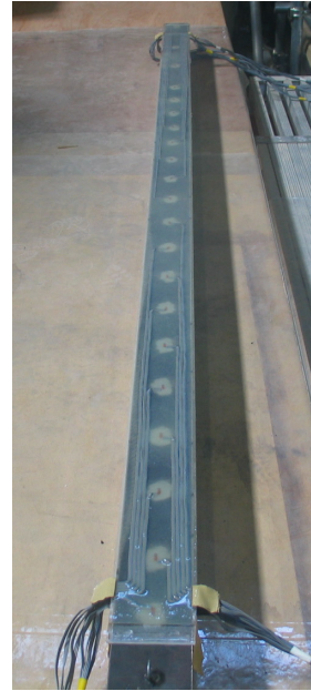
写真-2 単杭試験体
