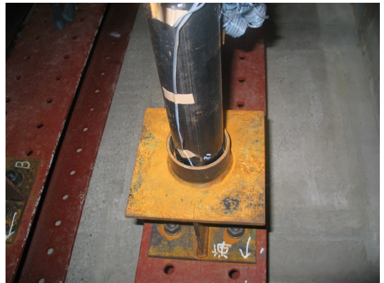
写真-9 海側杭(押込み側)下端ピン構造
