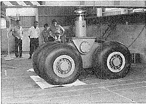
写真-2 タイヤプリント試験の状況
