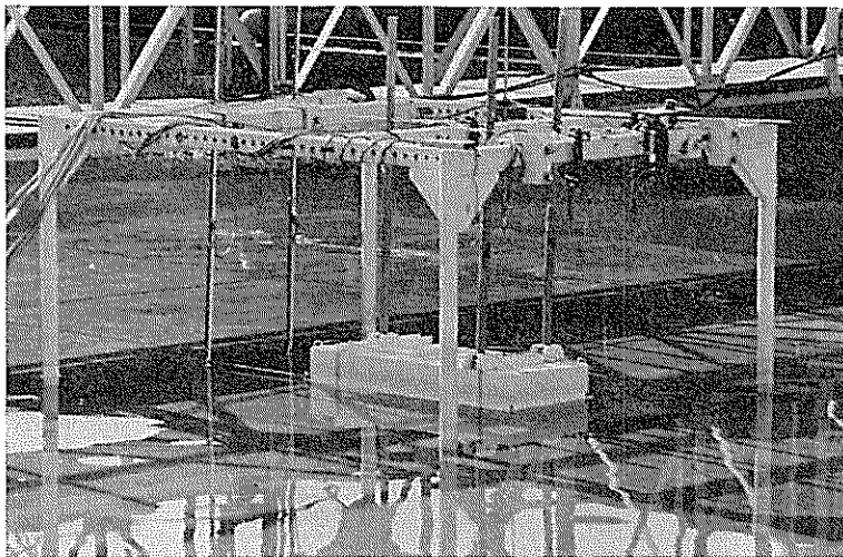
写真-1 船体固定時の波力測定状況
