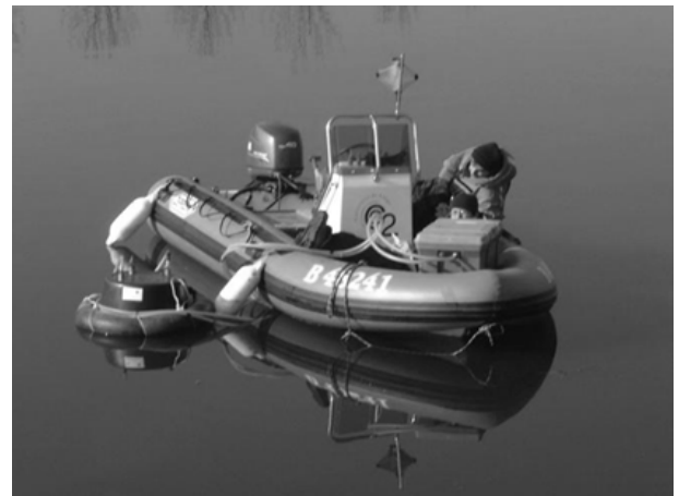
写真-5 一体式フローティングチャンバー装置。リージュ大学の HP より
