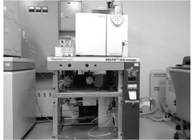
写真-16 元素分析計 (Thermo Finnigan 社製 Elemental Analyzer)
