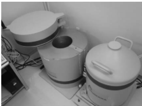
写真-17 低バックグラウンド仕様の井戸型ゲルマニウム半導体検出器
