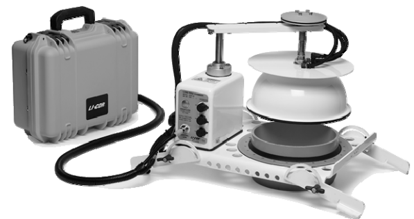
写真-6 底生系チャンバー装置 (LI-COR8100A)。LI-COR 社の HP より（写真の右側の機器のサイズは 30 cm×40 cm×20 cm 程度）
