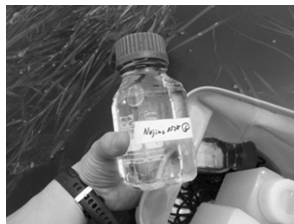
写真-3 水中CO 2 分圧用サンプルの採取の様子
