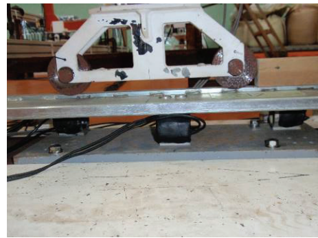
写真-3.5 レール下に設置したロードセル
