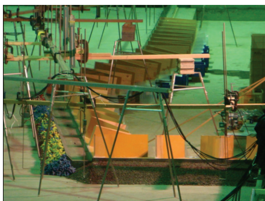
写真-4.1 越波マス及び導水板の設置状況 (越波排水路背後の後壁上の越波量計測時)
