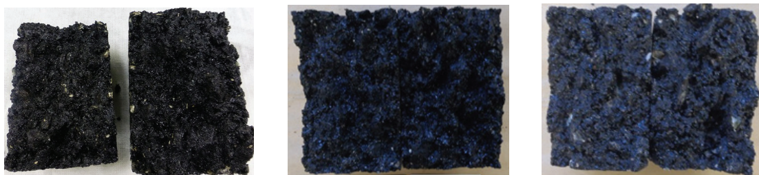
a) 温水養生 0 日 b) 温水養生 1 日 c) 温水養生 7 日
