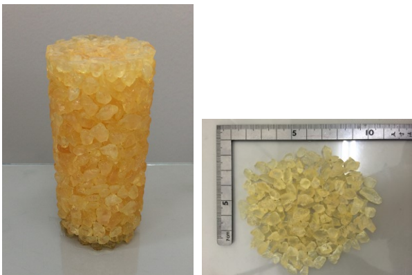
図-4.4 3次元造形された三軸供試体（左）と個別粒子の様子（右）
