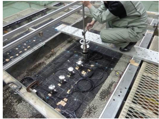
写真-3.3 FWD試験の様子
