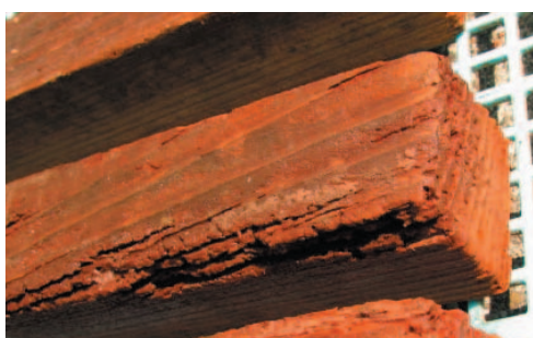
写真-10 干満帯設置4年後の低分子フェノール樹脂処理試験体の端部
