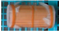
写真-A.3 メッシュ被覆 試験体の一例 (スギ, PE100 被覆)
