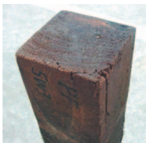
写真-9 海水浸漬2年後の低分子フェノール樹脂処理試験体の端部
