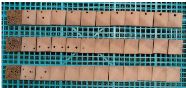
↑ 上端 (土砂表面高さ) ↑ 最下部 写真-16 上部5cmを海中に出して土中に埋めた試験体の2cm間隔切断面 (設置期間2年9か月)
