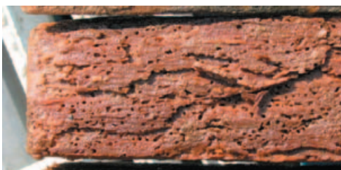
写真-11 干満帯設置8年後の低分子フェノール樹脂処理試験体の側面
