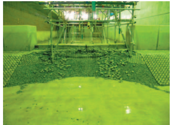
(c) 潜堤滑動時の被覆ブロックの被災状況 (ポンプ出力 70%作動後)
