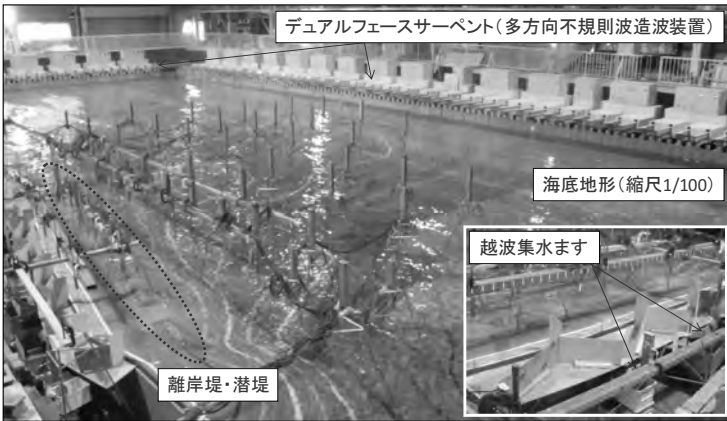
写真-3.3 大型平面水槽と海底地形模型
