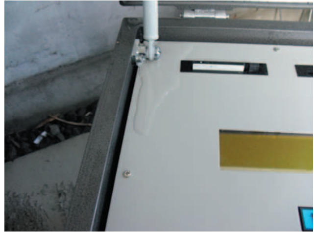
図-28 八戸港の強震観測小屋 一躯体内部にわずかに浸入していた海水— (平成 23 年 3 月 17 日撮影)
