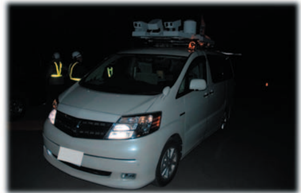
写真-1a 前方スキャン用の車載型レーザースキャナの外部観（車両と一体型）
