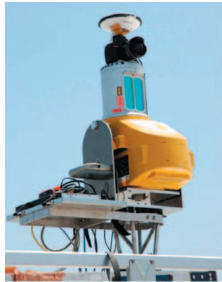
写真-2b 側方スキャン用の車載型レーザースキャナ (車両搭載部の拡大。今回の計測で使用した治具は異種のもので、かつ、夜間作業のためカメラは取り付けずに使用)
