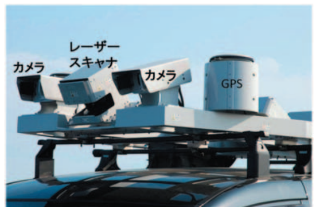
写真-1b 前方スキャン用の車載型レーザースキャナ（車両搭載部の拡大）
