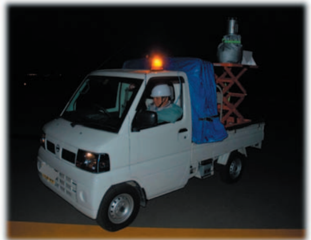
写真-2a 側方スキャン用の車載型レーザースキャナの外部観 (車載状況)
