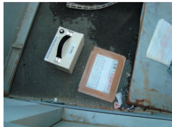
写真-3.15 余震観測を実施した場所と地震計の設置状況
