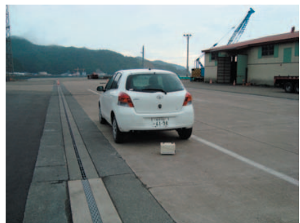
写真-3.8 須賀地区棧橋 (-7.5m) における微動観測状況
