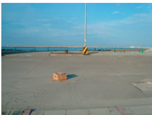
写真-3.18 1 号埠頭における微動観測状況
