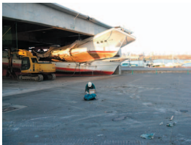
写真-3.2 諏訪下地区栈橋（-6.0m）における微動観測状況
