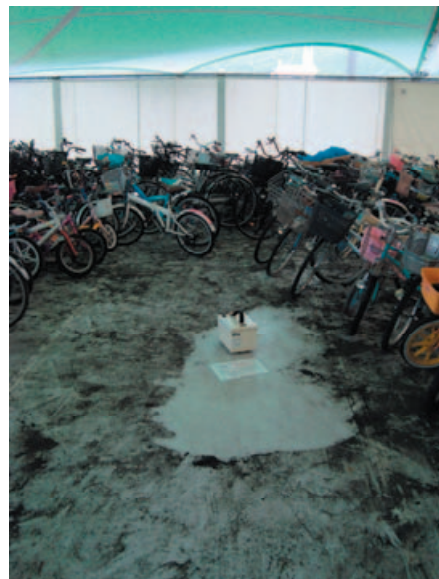
写真-3.11 釜石港で余震観測を実施した場所(右のテント)と地震計の設置状況
