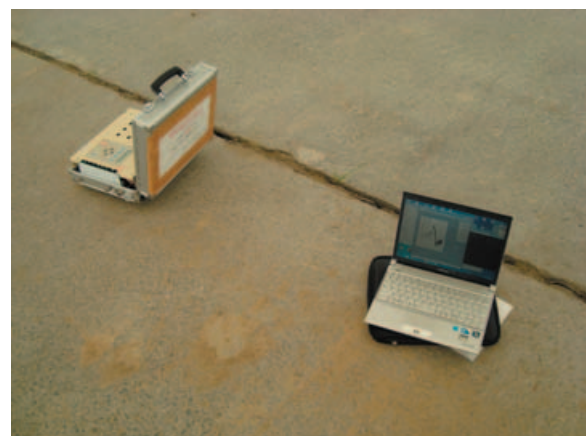
写真-3.13 野々田地区 No.6 地点における微動観測状況
