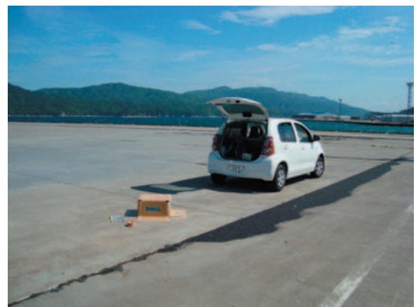
写真-3.5 藤原地区岸壁 (-12m) における微動観測状況
