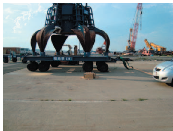
写真-3.19 2 号埠頭における微動観測状況
