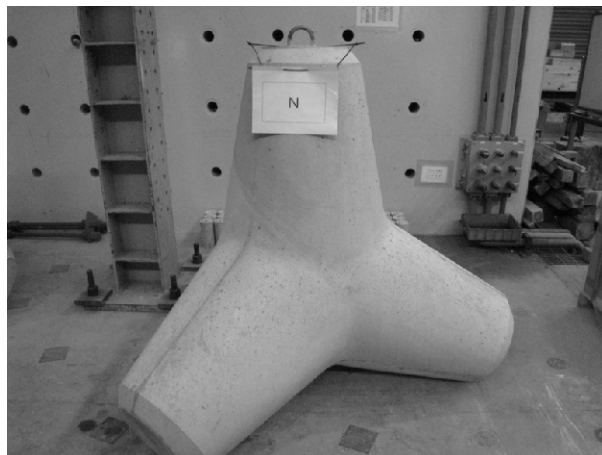
写真-4.5 配合 65-0 (ブリーディング量 0.06\text{cm}^3/\text{cm}^2 )
