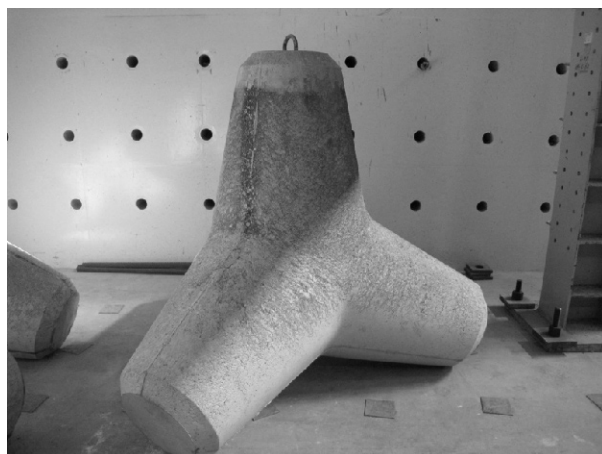
写真-4.6 配合 65-70 (ブリーディング量 0.87\text{cm}^3/\text{cm}^2 )
