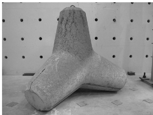
写真-4.7 配合 65-100 (ブリーディング量 0.37\text{cm}^3/\text{cm}^2 )
