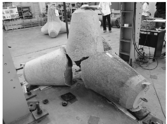
付図-7 脚部3本の折損状況 (65-70_1)
