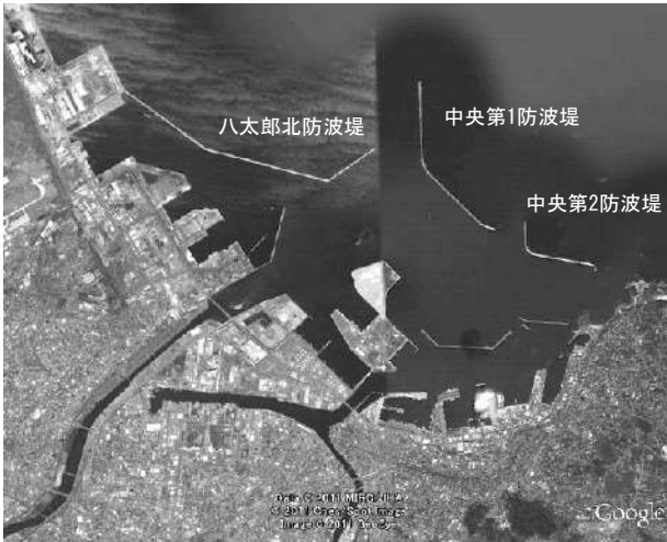
図-5.1.1.13 八戸港の防波堤配置
