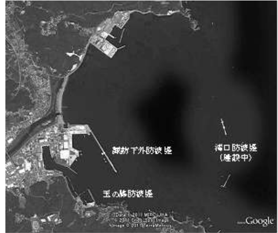
図-5.2.1.12 久慈港の防波堤配置（被災前）
