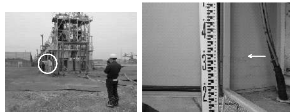
図-5.4.2.3 小名浜港第4埠頭における津波痕跡(左写真:全景,右写真:チャ新中央の1階建の建物内の水跡を対象)
