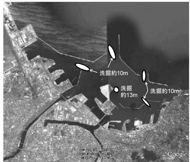
図-5.1.1.18 八戸港における洗掘
