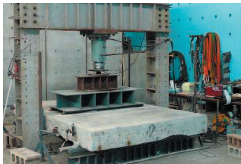
写真-2 曲げ載荷試験の一例（部材No.Sa-8）
