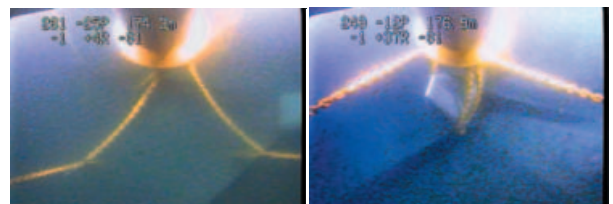
写真-4.6 水中翼との遭遇 写真-4.7 水中翼の拘束
