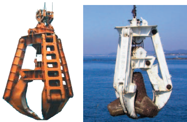
写真-1.2 自重開閉によるグラブ式把持装置 2)
