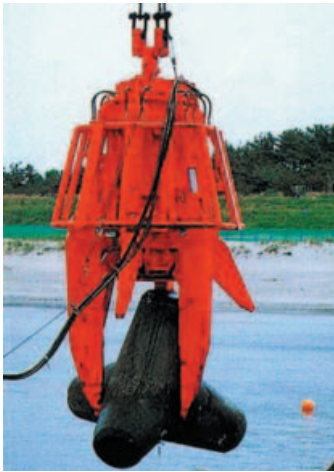
図-1.1 油圧開閉によるグラブ式把持装置 4)
