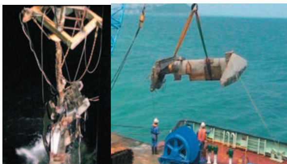
写真-4.15 水中翼の回収 写真-4.16 回収された水中翼
