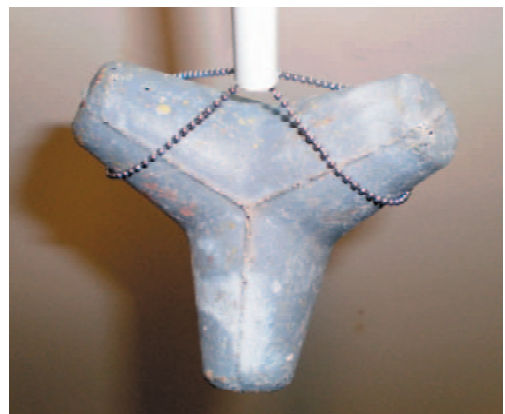
写真-5.4 摩擦が無い状況でのブロック模型吊り上げ
