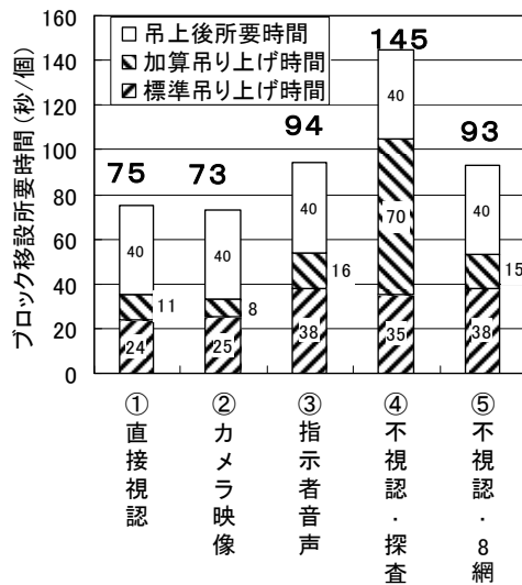
図-2.7 各実験ケースにおけるブロック模型移設時間
