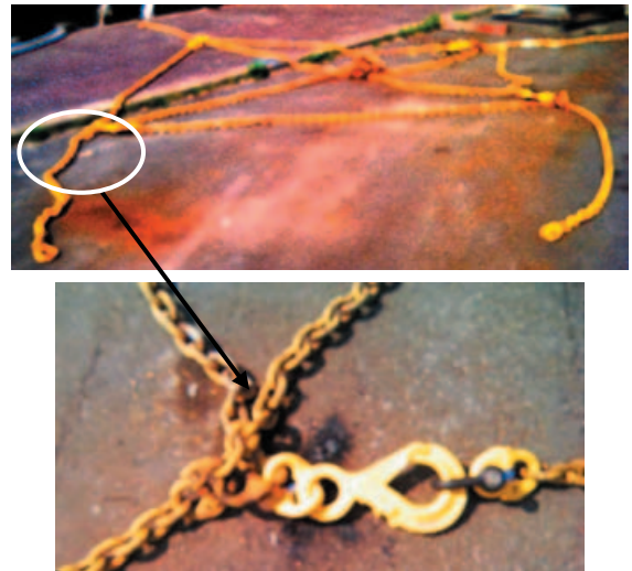
写真-3.10 フックを挿入した網チェーン
