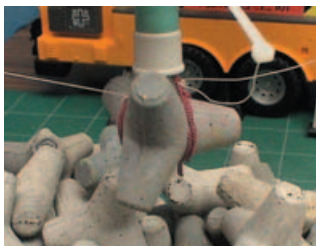
写真-2.11 ブロック模型の吊り上げ
