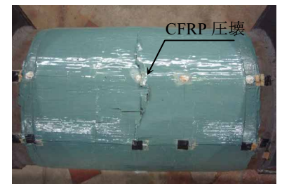
写真-3.2 破壊状況 (No.1 供試体)
