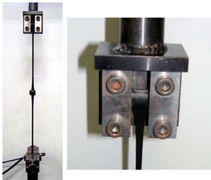
図-5.2.4 結節点強度試験状況
