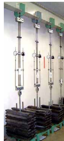
図-5.2.5 クリープ試験状況
