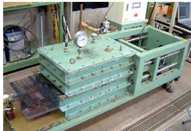
図-5.3.1 引抜き試験装置
