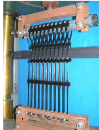
図-5.2.8 連結部強度試験状況
