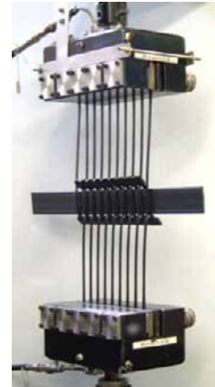
図-5.2.3 接続強度試験状況
