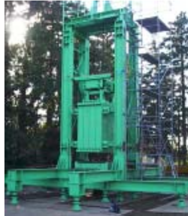
図-5.11 重錘落下方式急速載荷試験
