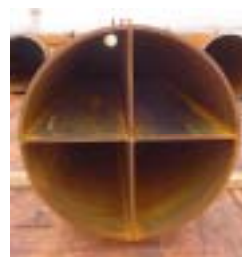
写真-B.1 十字リブの設置例
