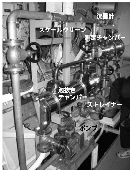
図-9 水質計測装置
