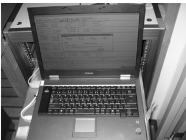
図-7 ADCP,水質測定装置データ処理用PC 長時間の停電対策と設置スペース縮小化のためノートPCを採用した
