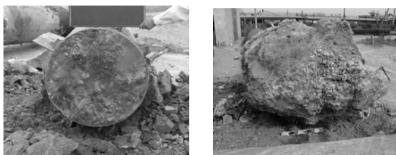
A 先端部断面 B 先端部形状 b) No.9 根固め部形状
