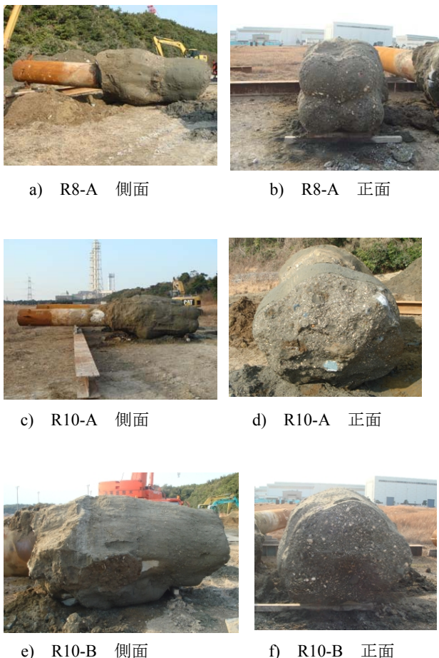
図-5.31 根固め部掘起し状況
