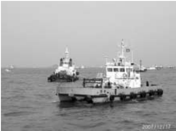
写真—7 小型の油回収船 17)
