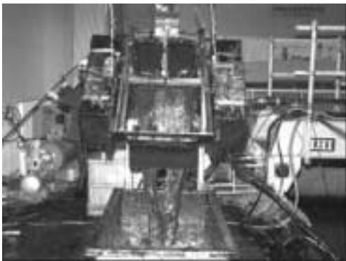
写真-6(d) 本体を傾け、貯油タンクに油水を回収 写真-6 かき寄せバケット式スキマー模型実験
