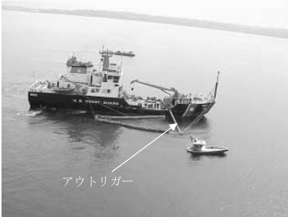
写真-13 USCGのアウトリガータイプの集油装置
