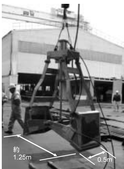
写真-4 製作したグラブバケット4分の1模型
