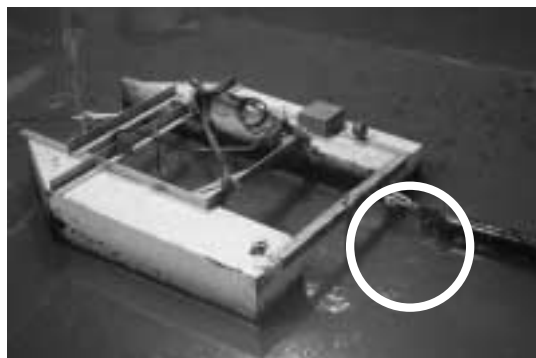
写真-20 オイルブーム取付け位置の変更
