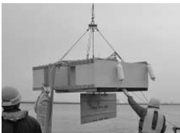
写真-19 自動展張ブイプロトタイプ（後面および大型の翼板）
