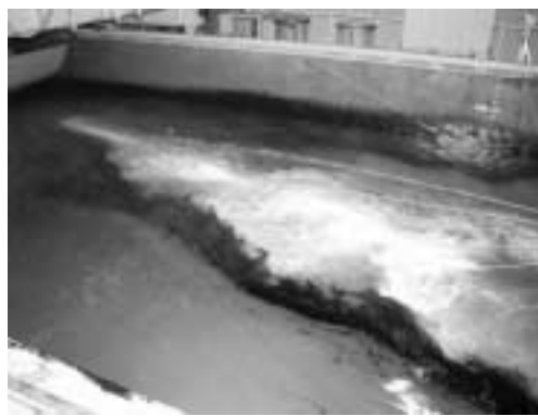
写真-16 ジェット水による導流効果
