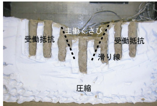
(b) 砂杭の破壊状況
