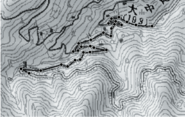
図-5.9 ルートポイントの作成例 (—がルート, ●がルートポイント. ポイントはカーブあたり1つで作成した.)
