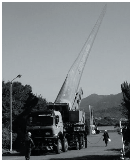
写真-2.2 ブレード起立装置 (日本通運株式会社ホームページ)
