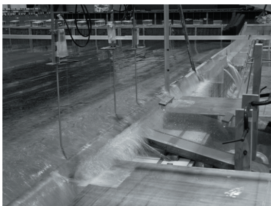
写真-4 波の作用状況(津波高 2m)
