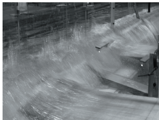
写真-5 波の作用状況(津波高 4m)
