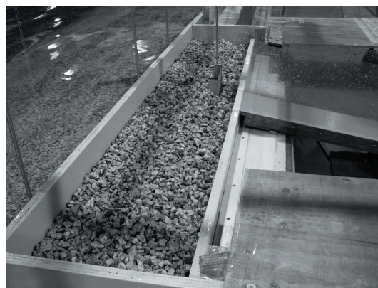
写真-7 石材飛散状況(津波高 4m)
