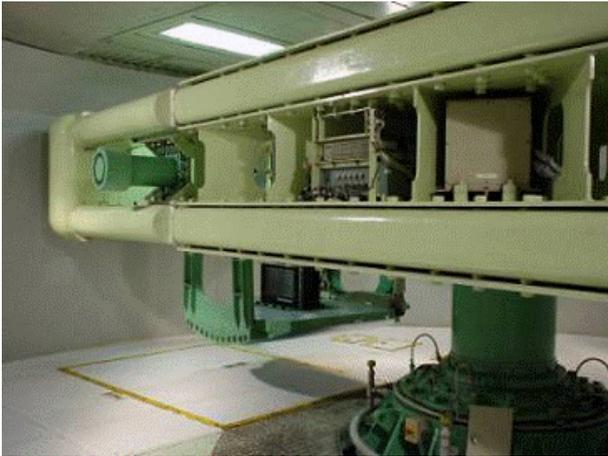
図-1 遠心模型実験装置
