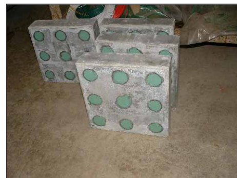
写真-4 すりへり試験後の供試体
