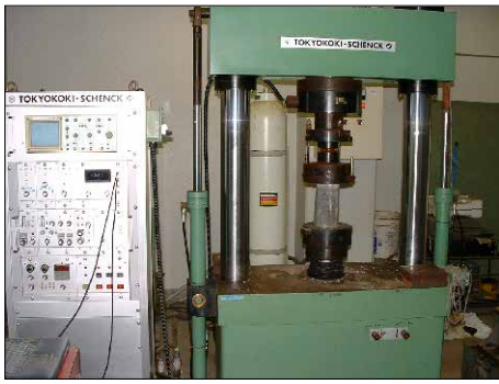
写真-5 圧縮疲労試験の状況
