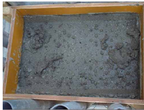
(b) 加振後におけるコンクリート表面の状況
