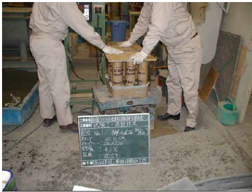
写真-8 締固め状況
