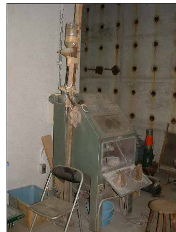
写真-3 すりへり試験器
