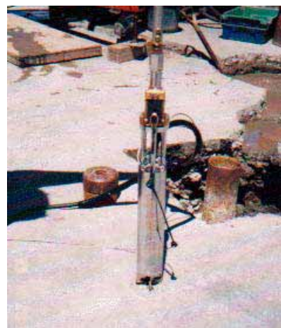
図-6 ERS-F, G, GV 型強震計の地中設置用換振器
