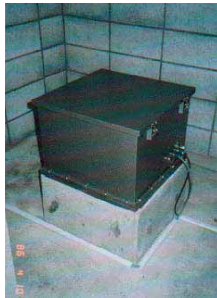
図-5 一体型の ERS-F 型強震計
