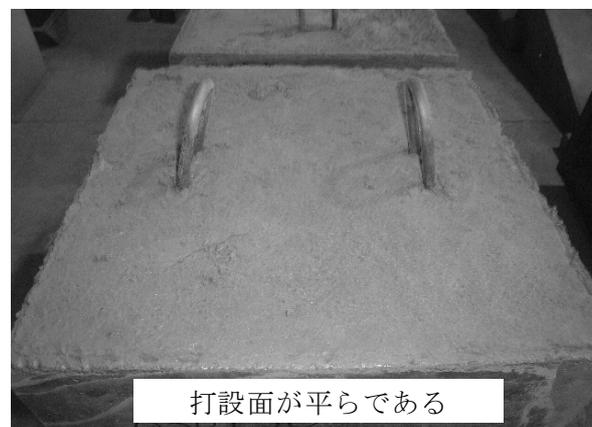
写真-4 改質硫黄の含有量が少ない場合の打設面
