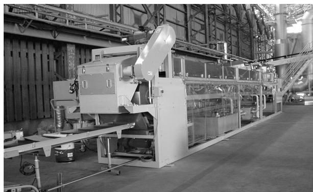
図-A.5 硫黄中間資材をフレック化する装置
