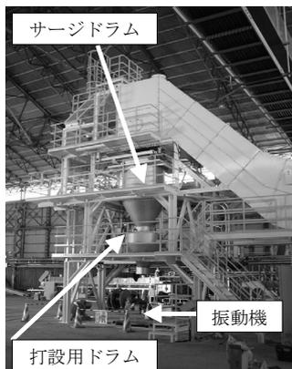
図-A.4 打設設備
