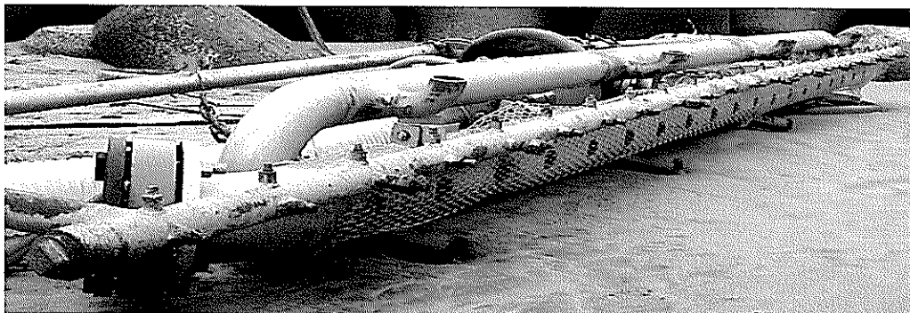
写真-2 砂集積実験装置有孔管部
