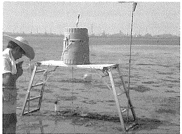
写真-3 自動採水器の設置状況
