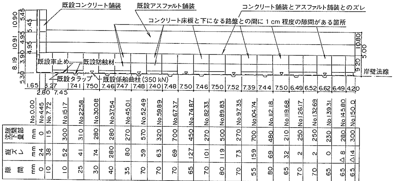
図-3.1.28 昭和南3号岸壁 (-7.5m)被災状況平面図
