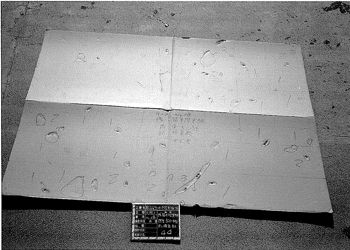
写真-4(a) 載荷底版と捨石の接触状況（均し精度±20cm(case20)、接地圧120kPa）
