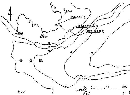
図・1・1-18 釜石港波高計設置要領圖 (平面図)
